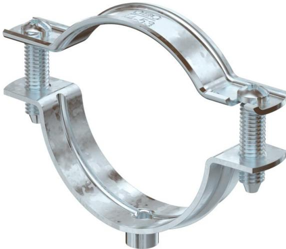
Collier d'écartement pour le montage de tubes et câbles au mur, au plafond et au sol. Avec partie supérieure autobloquante. Fixation par l'embase avec filetage intérieur. Surfaces G et FT à partir de la taille 20 des colliers convenant au montage avec cloueur ou pistolet de scellement.
