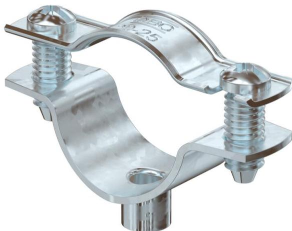
Collier d'écartement pour le montage de tubes et câbles au mur, au plafond et au sol. Avec partie supérieure autobloquante. Fixation par l'embase avec filetage intérieur. Surfaces G et FT à partir de la taille 20 des colliers convenant au montage avec cloueur ou pistolet de scellement.
