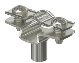
Collier d'écartement pour le montage de tubes et câbles au mur, au plafond et au sol. Avec couvercle autobloquant. Fixation par l'embase avec filetage intérieur. Autorisé pour la maintenance conformément à la norme DIN 4102, partie 12, classes de maintenance E 30 jusqu'à E 90.
