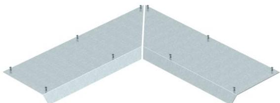
Couvercle en 2 parties pour recouvrir le coin intérieur d'un conduit en saillie, compatible avec les socles de conduit AIK/U, livrée 10 vis de fixation. Le couvercle de conduit est fermement vissé sur les profilés latéraux de la partie inférieure du conduit. Le chanfrein du couvercle dépasse du socle du conduit selon un angle de 45°.
