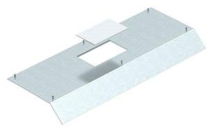
Couvercle pour socle de conduit AIK/U pour le montage d'un boîtier de sol de taille nominale 2 ; ouverture de montage fermée par un obturateur en alu de 2 mm. Le couvercle de conduit est fermement vissé sur les profilés latéraux de la partie inférieure du conduit. Le chanfrein du couvercle dépasse du socle du conduit selon un angle de 45°.
