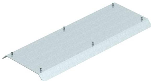
Couvercle en saillie pour recouvrir le conduit de dérivation sur sol AIKA, compatible avec les socles de conduit AIK/U. Le couvercle de conduit est vissé dans les profilés latéraux AI du socle du conduit. Le chanfrein du couvercle dépasse des deux côtés du socle du conduit selon un angle de 45°.
