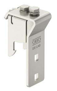
Écarteur pour montage décalé de couvercles sur des chemins de câbles longue portée et des échelles à câbles longue portée. Hauteur d'écart 35 mm, acier inoxydable 1.4301.
