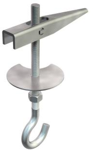
1 rondelle plate et 1 écrou hexagonal, avec crochet de plafond. Attention : pour les suspensions pour luminaires, la sécurité doit être multipliée par cinq.
