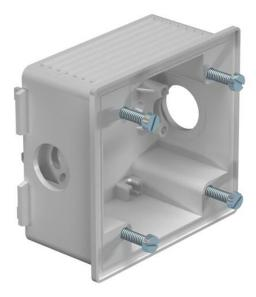
Boîtier d'appareillage pour le montage de prises de courant CEE dans les goulottes WDK à partir d'une largeur de goulotte de 150 mm. Le boîtier d'appareillage peut être également monté comme boîte d'encastrement pour les appareillages CEE. Modèle droit, 16 et 32 A, avec un écartement des trous de 60 x 60 mm Livrée complète avec 1 collier de décharge de traction
