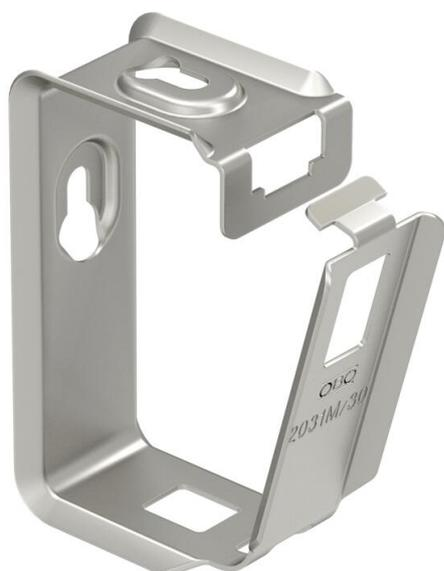
Passe-câbles métalliques pour une résistance mécanique élevée, même en cas d'incendie. Approprié pour un montage sécurisé au-dessus de plafonds coupe-feu. Autorisé également comme variante spécifique pour la sécurité de fonctionnement électrique selon la norme DIN 4102 partie 12. Pour montage au mur et au plafond. Fermeture ouvrable sans outil.
