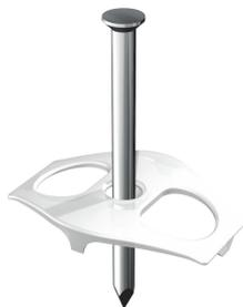
Avec clou en acier galvanisé, Ø 3 mm ou 3,5 mm pour la fixation de conduits dans les fentes de mur et sur la maçonnerie de 1 ou 2 conduits NYM 3 x 1,5/2,5 mm<sup>2</sup> ou 1 ou 2 conduits NYM 5 x 1,5/2,5 mm<sup>2</sup>.
