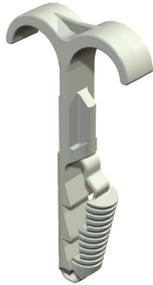
Les colliers emboîtables sont destinés à la pose de câbles et de tubes sur les murs et plafonds ainsi qu'à la pose de tubes flexibles sur les supports en béton et en plâtre. Les doubles colliers emboîtables remplacent les clips de fixation à clou dans le béton et le béton cellulaire. L'avantage des colliers emboîtables est qu'ils doivent simplement être emboîtés dans le trou de montage. L'utilisation de chevilles et de vis devient alors inutile.
